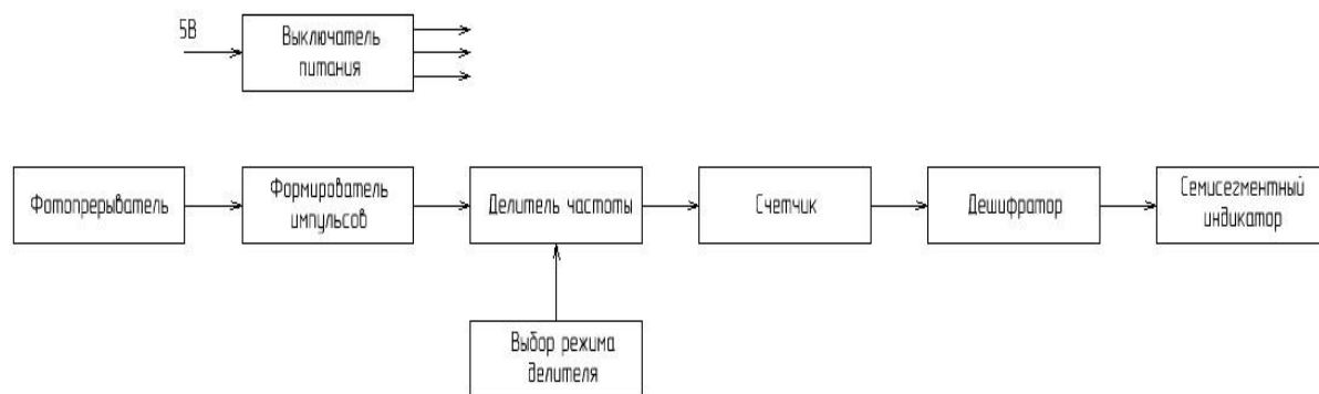
Рисунок 1 – Структурная схема устройства
